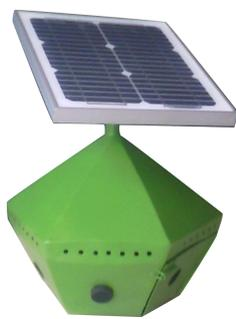
Gambar 3. Prototype pengusir hama burung
